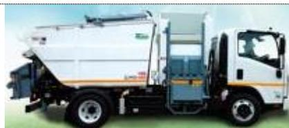
Autocarro bicamera, con vasca semplice da 2,5/3 metri cubi e vasca costipatrice da 7/8 metri cubi
