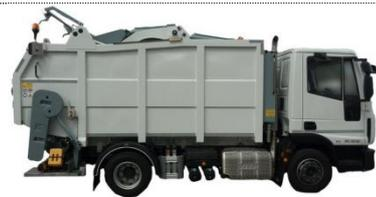
Compattatore da 10 mc su telaio due assi
