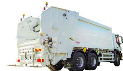
I **mezzi madre** sono invece compattatori di grandi dimensioni, di volumetria superiore ai 22 mc, compatibili all'accoppiamento con i mezzi satellite per il trasbordo dei rifiuti.
