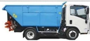
Autocarro con vasca semplice di capacità di 5 metri cubi con voltabidone e voltacassonetti, impiegati nella viabilità ordinaria
