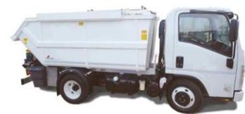
Autocarro con vasca di capacità di 7 metri cubi con costipatore, volta bidone e voltacassonetti, impiegati nella viabilità ordinaria
