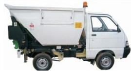
Autocarro tipo Porter o similare, con vasca di capacità 2,5-3 metri cubi impiegati prevalentemente nei centri storici e nelle strade a viabilità ridotta
