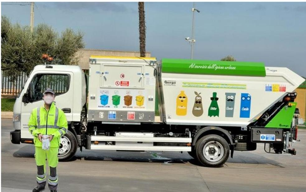
Il sistema in esame è composto da un mezzo di ridotte dimensioni, nello specifico con due vasche di conferimento distinte, dotato di un allestimento tecnologico flessibile sia nell'hardware che nel software che lo gestisce.
